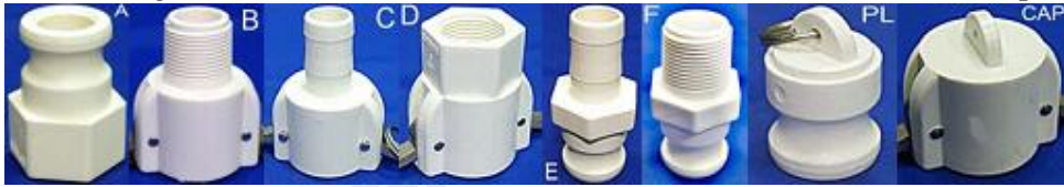
A 公接頭 x NPT 內牙 B 母座 x NPT 外牙 C 母座 x 管鉤接頭 D 母座 x NPT 內牙 E 公接頭 x 管鉤接頭 F 公接頭 x NPT 外牙 CAP 公接頭蓋 PL 母座止栓
